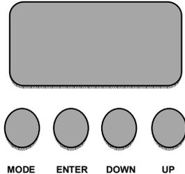
Über die MODE Taste gelangen Sie ins Menü. Durch Drücken der UP/DOWN-Tasten können Sie sich im Hauptmenü bewegen. Zur Auswahl des gewünschten Menüpunktes drücken Sie die ENTER-Taste. Durch Drücken der UP/DOWN-Tasten können Sie die Auswahl verändern. Bestätigen Sie jede Änderung durch Drücken der ENTER-Taste. Der jeweilige Modus kann durch die MODE-Taste verlassen werden. Die jeweiligen Funktionen werden im Folgenden aufgeführt.
