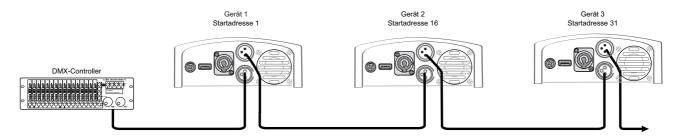
Achten Sie darauf, dass die Adern der Datenleitung an keiner Stelle miteinander in Kontakt treten. Die Geräte werden ansonsten nicht bzw. nicht korrekt funktionieren.
