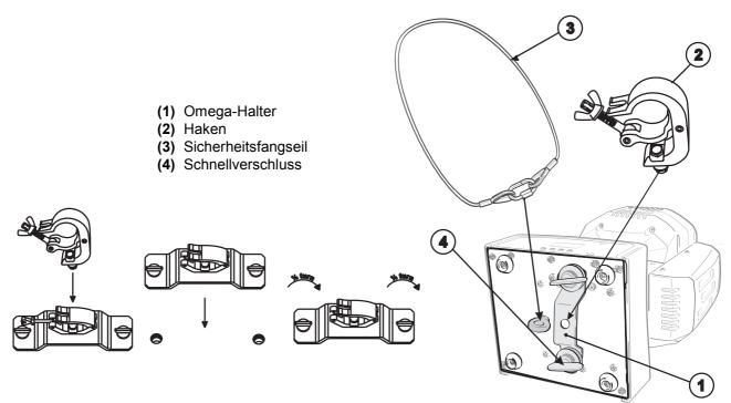
Das Gerät kann auf dem Boden aufgestellt oder an einer Traverse oder einer anderen geeigneten Struktur befestigt werden. Die Montage darf niemals freischwingend erfolgen.
