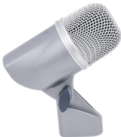
Das MIC 77L ist ein dynamisches Instrumentenmikrofon für die Abnahme von tieffrequenten Instrumenten wie Bassdrums. Die große Membran bildet tiefe Frequenzen optimal ab. Die Nierencharakteristik isoliert die Signalquelle und reduziert effektiv die Aufnahme von Hintergrundgeräuschen. Durch das zinkverstärkte Druckgussgehäuse ist das Mikrofon optimal für Touring-Anwendungen, aber auch für den Studio-Einsatz einsetzbar.
