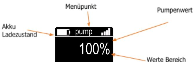
Die Bedienung der Piccola erfolgt über die drei Tasten (Minus/links, Plus/Rechts, Enter) und dem OLED-Display. Im oberen Teil des Displays kann links der Ladezustand des Akkus abgelesen werden. Im rechten oberen Teil wird die gewählte Nebelmenge angezeigt. Mittig dazu ist der gewählte Menüpunkt angezeigt. Im unteren Teil des Displays sind die jeweiligen Werte dargestellt.
