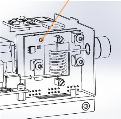
Der Verdampfer kann nun durch Hebeln mit einem kleinen Schraubendreher durch die beiden Öffnungen gelöst werden.
