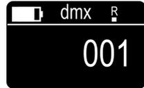
Wird ein gültiges DMX Signal empfangen, erscheint über der Mengenanzeige ein kleines „R“.
