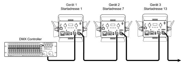
Für die Ansteuerung des Geräts per DMX512 ist eine Datenverbindung notwendig. Das Gerät verfügt dazu über 3-polige XLR-Anschlüsse.
