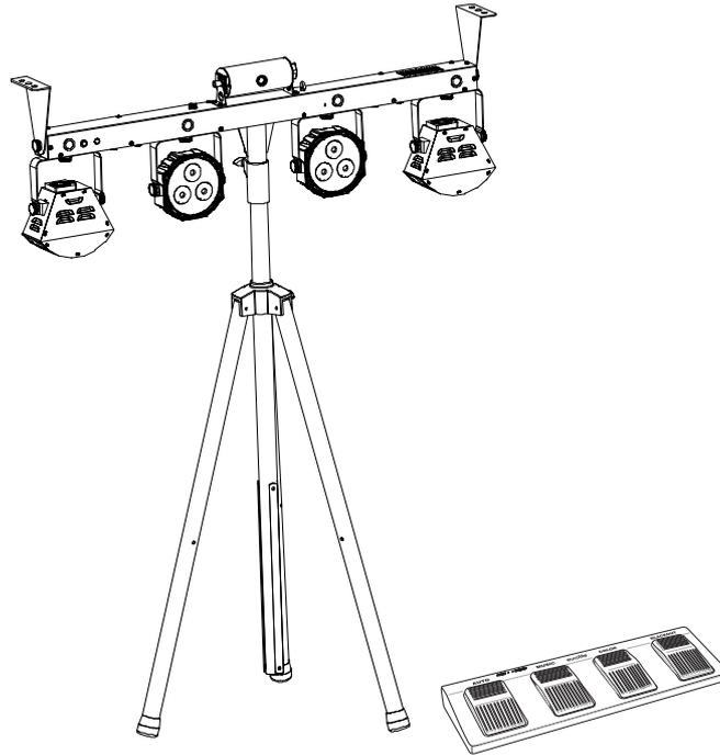
Für den mobilen Einsatz setzen Sie das Lichtset über die Stativhülse auf ein Stativ auf und fixieren es mit der Feststellschraube. Passende Stative finden Sie im Kapitel *Zubehör*.
