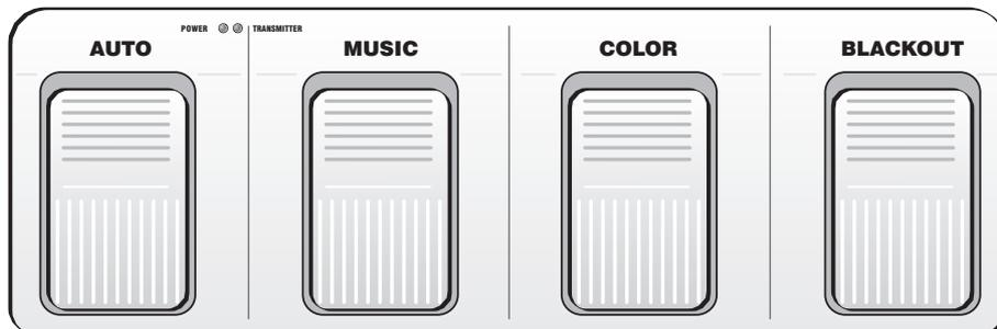
Das Lichtset lässt sich mit dem optionalen Fußschalter über eine Distanz von bis zu 30 Metern (Sichtlinie) fernsteuern. Der Fußschalter funktioniert nur im Standalone-Betrieb, er kann nicht im DMX- oder Slave-Betrieb verwendet werden. Es können die integrierten Showprogramme im Automatikbetrieb oder im musikgesteuerten Betrieb aufgerufen werden oder der Farbmodus.
