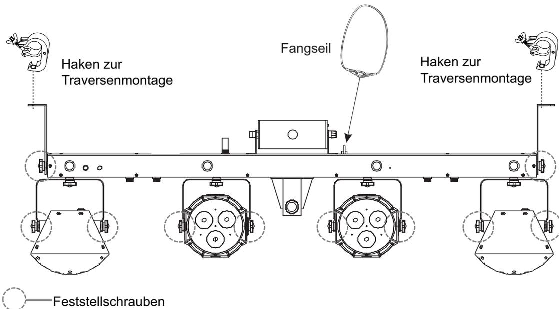
Das Gerät ist zur Überkopfmontage über die Montagebügel vorgesehen. Montieren Sie es über die Bügel an einer Wand oder einer Decke. Alternativ kann es auch mit geeigneten Haken über die Bügel an einer Traverse befestigt werden.
