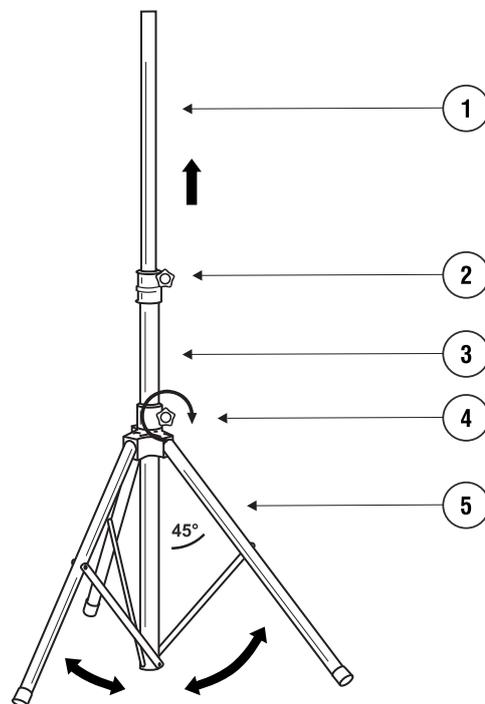
**Öffnen der Stativbeine** - Die Fixierschraube (4) der Stativbeine (5) lösen und diese nach außen ziehen. Die Fixierschraube wieder festziehen.
