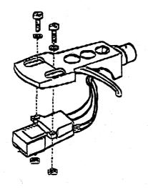
Nach der Montage der Verbindungsleitungen befestigen Sie den Tonabnehmer mit den beiliegenden Schrauben unter dem Systemhalter.
